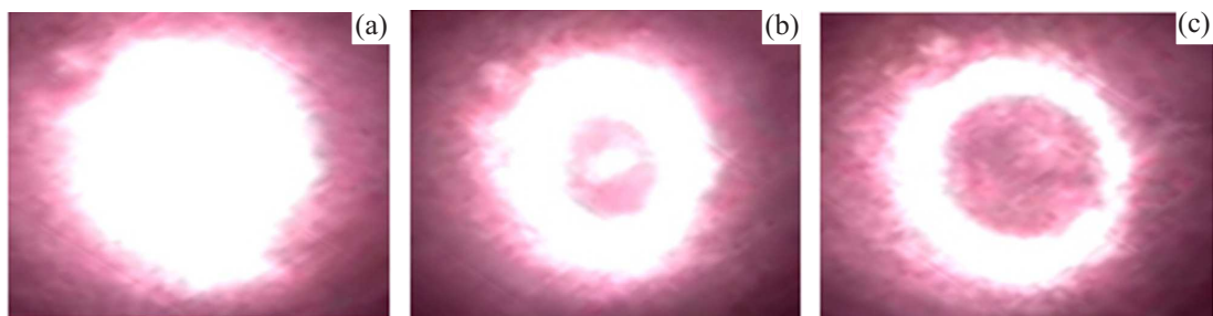
Рис.4. Изменение изображения на экране при увеличении интенсивности лазера
