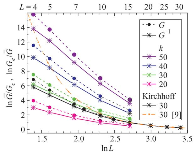
Рис. 3. (Цветной онлайн) Зависимости  $\bar{G}(L)/G_e$  (пунктир) и  $G_e \bar{G}^{-1}(L)$  (сплошные линии) для квадратных решеток в случае  $g_i = \exp(-kx_i)$  при указанных  $k$ . Короткие линии на отрезке  $4 \leq L \leq 15$  – расчет по распределениям  $P(x_c)$  из рис. 2. Линии вплоть до  $L = 30$  при  $k = 30$  – расчет по Кирхгофу и теоретическая кривая из работы [9] (см. текст)
