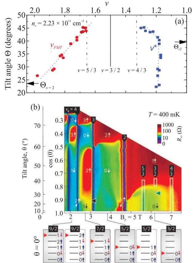
Рис. 2. (Цветной онлайн) (a) – Зависимости факторов заполнения точки антипересечения  $\nu^*$  (квадратные символы) и ферромагнитного перехода  $\nu_{FMT}$  (круглые символы) от угла наклона магнитного поля. (b) – Магнитотранспортная карта, взятая из [13] для образца ZnO с  $n_s = 2.3 \times 10^{11} \text{ cm}^{-2}$ . Важно: указанные направления спинов везде инвертированы (в оригинале взят противоположный знак  $g$ -фактора)
