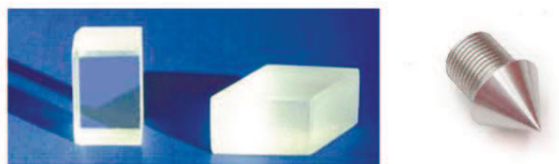
Рис. 1. (Цветной онлайн) Форма исследованных образцов и конический ударник
