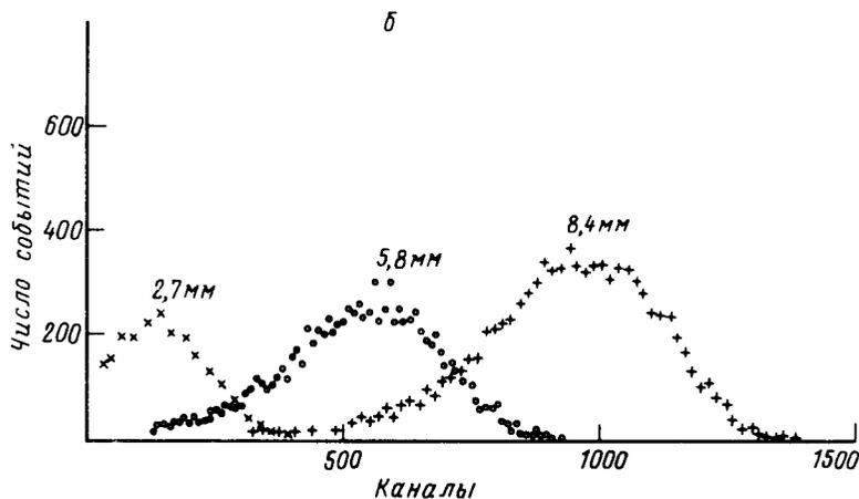
Амплитудные спектры со сцинтиляционного счетчика: а — кристаллы разориентированы ( $\theta \geq 30$  мрад); б — кристаллы ориентированы ( $\theta = 0$  мрад). Число событий в каждом канале спектров нормировано на полное число событий (толщины кристаллов вольфрама показаны над спектрами)
