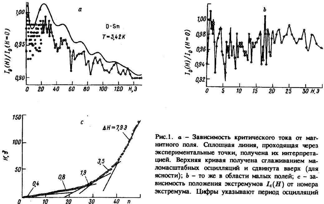
Рис.1. а – Зависимость критического тока от магнитного поля. Сплошная линия, проходящая через экспериментальные точки, получена их интерполяцией. Верхняя кривая получена сглаживанием маломасштабных осцилляций и сдвинута вверх (для ясности); б – то же в области малых полей; с – зависимость положения экстремумов  $I_c(H)$  от номера экстремума. Цифры указывают период осцилляций
