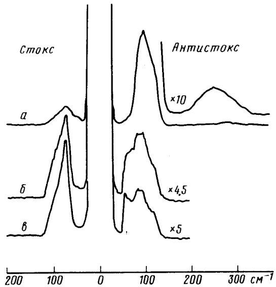
Спектrogramмы комбинационного рассеяния атомами ксенона, адсорбированными в пористом стекле. Разрешение —  $2 \text{ см}^{-1}$ , скорость записи —  $15 \text{ см}^{-1}/\text{мин}$ , постоянная времени — 2 сек, длина волн лазера — 488 нм. *a* — Запись спектра после 10 час. облучения; *b* — запись спектра после 20 час облучения; *c* — запись спектра после 30 час облучения
