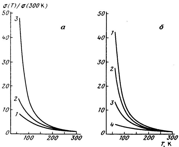
Температурная зависимость электропроводности, рассчитанная по формуле (2) и приведенная к ее значению при комнатной температуре:  $a - w = 0,013 \text{ эВ}, 1 - \gamma = 0,1; 2 - \gamma = 0,5; 3 - \gamma = 0,999; b - 1, 2, 3 - \gamma = 0,999, 1 - w = 0,026 \text{ эВ}, 2 - w = -0,26 \text{ эВ}, 3 - w = 2,6 \text{ эВ}, 4 - \gamma = 0,5, w = 0,065 \text{ эВ}$
