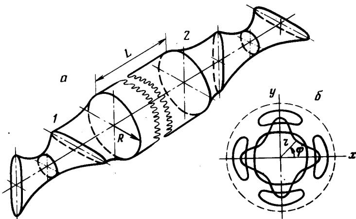
Амбиополярная ловушка. *a* – геометрия магнитного поля:  $L$  – длина центральной части ловушки,  $R$  – радиус ловушки в центральной части; *б* – сечения нескольких дрейфовых поверхностей ионов экваториальной плоскостью ловушки; образование отдельных островков ("бананов") характерно для случая  $\beta = 8\pi n(T_e + T_i)/H^2 \sim 1$ .
