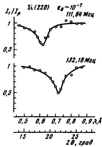
Зависимость относительной интенсивности отражения (220) от длины волны рентгеновского излучения.  $I_1$  и  $I_p$  – интенсивности отражения при включенном и выключенном генераторе звука,  $2\theta$  – удвоенный брэгговский угол,  $\epsilon_0$  – амплитуда деформации
