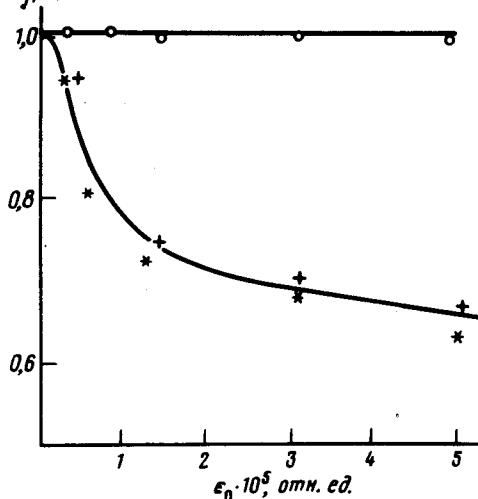
Экспериментальные зависимости изменения интенсивностей различных компонент ЯМР (пропорциональных различным заселеностям смежных пар уровней) ядер  $Al^{27}$  в лейкосапфире от амплитуды деформации при акустическом насыщении гексадекапольных переходов  $5/2 \leftrightarrow -1/2$ :
