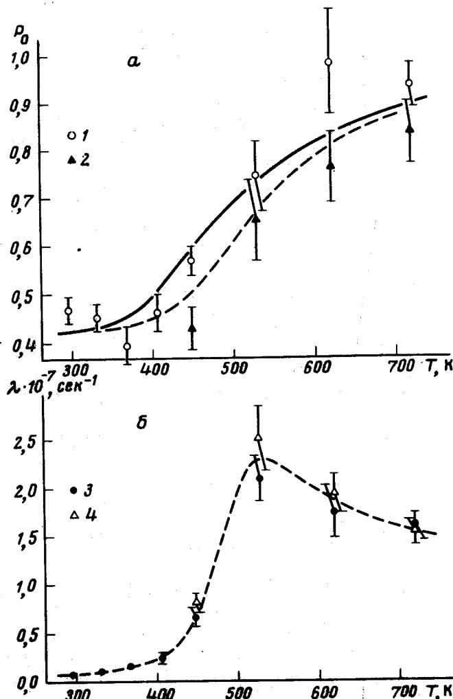
Зависимость начальной поляризации (a) и скорости релаксации (б) спинов  $\mu^+$ -мезонов в кремнии от температуры. Ось абсцисс — абсолютная температура, ось ординат — а) значения начальной поляризации  $P_0$ , б) — скорость релаксации  $\lambda$ . Кривые 1, 3 — при напряженности магнитного поля 236 э, кривые 2, 4 — при 472 э. Плавные кривые рис. а — расчет по теории мюониевой деполяризации
