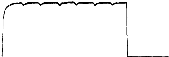
Рис. 1. Осциллограмма СВЧ импульса, прошедшего через резонатор: \tau_{\text{имп}} = 1,8 \text{ мсек} , T = 1,2 \text{ К} , H = 2,1 \text{ кэ} , P/P_c = 14 \text{ дб}
