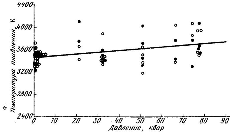
Кривая плавления рения: ○ – температуры измерялись по  $I_2(\lambda_2) / I_3(\lambda_3)$ ; ● – температуры измерялись по  $I_1(\lambda_1) / I_2(\lambda_2)$ .
