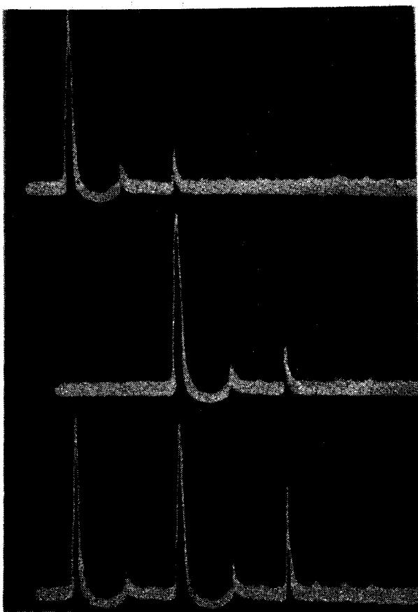
Верхние осциллограммы: подача на образец по отдельности первого и второго возбуждающего СВЧ импульса; нижняя осциллограмма: результат двухимпульсного воздействия на образец с интервалом между СВЧ импульсами  $2\tau_0$ . Через время  $4\tau_0$  после первого СВЧ импульса наблюдается сигнал эхо
