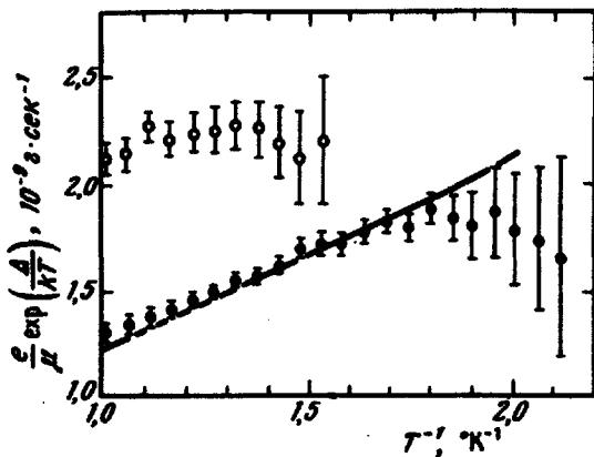
Ротонный вклад в подвижность положительного ( $\downarrow$ ) и отрицательного ( $\Phi$ ) ионов [9]. Кривая – расчет по формуле (8)
